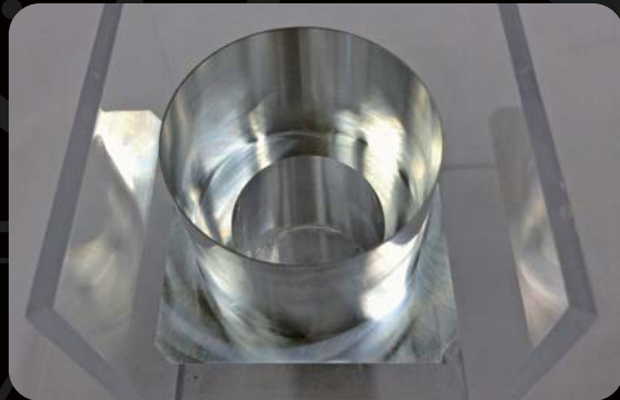
アルミ切削加工 (加工後板厚 0.5mm)
